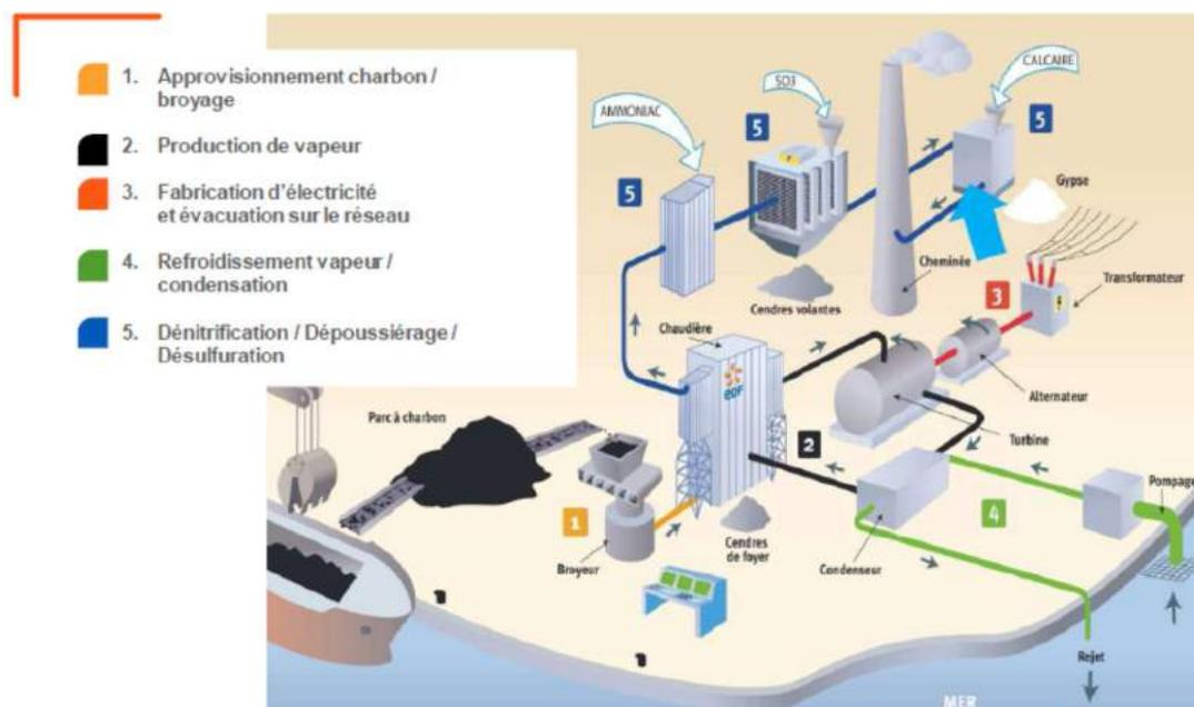
Figure 6 : Schéma de principe, fonctionnement d'une centrale charbon
