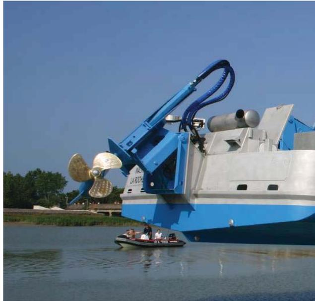
*Propulseurs hydrauliques escamotables*
